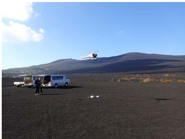
写真 11 無人航空機によるマイクロ波送受電および GNSS データ回収実験
