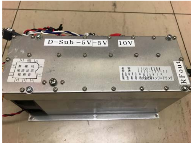
写真1 マイクロ波電力送電器 (5.81GHz 帯送電機)
