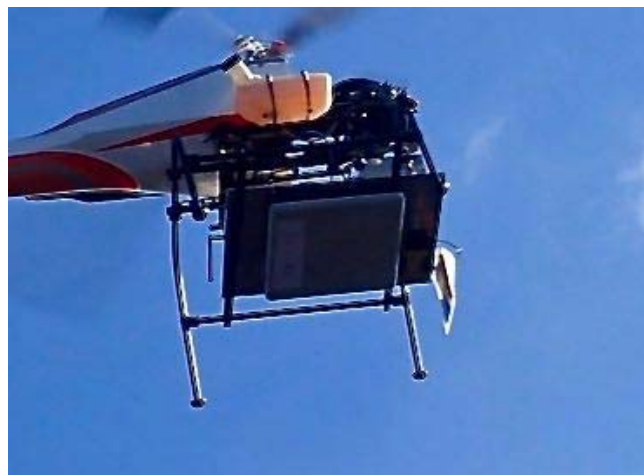
写真2 広域照射タイプ送電アンテナ
