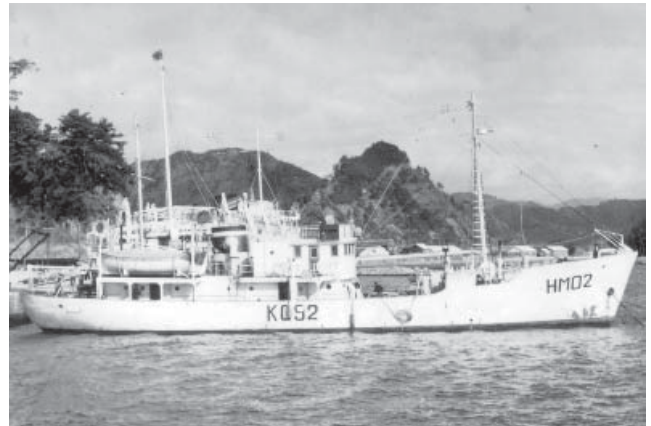
図 1 第五海洋丸. 全長 34 m, 280 排水トン. 1943 年竣工. 海上保安庁測量船として日本の海上交通の復旧に努めたが、1952 年、明神礁付近で遭難した。
